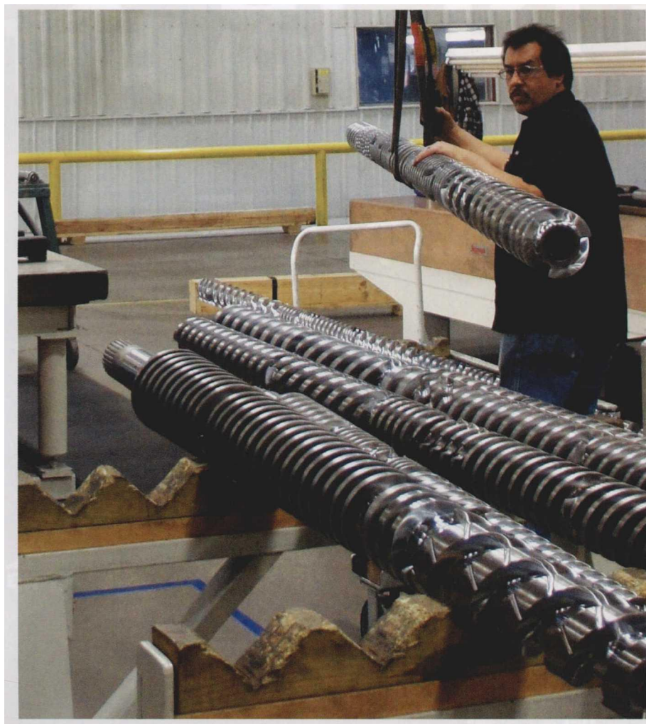
图1 除了分布在安装过程中的40多个不同步骤的不同处理顺序外，Wear Technology 精益生产改革的努力由于挤出螺杆倾向于沉重，让CNC 操作员 Nick Bowen 等员工觉得难以管理，并且难以通过拥挤的工位来操作
