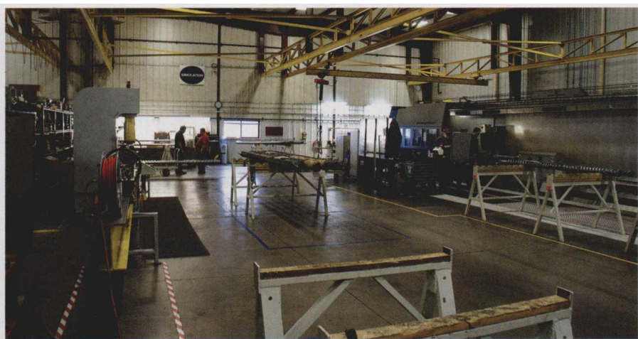
图 6 重新安置在仓库中使用的引入螺丝的预检，使黄色印刷机移动到更靠近右侧的 Weingartner 铣刀（无法移动）的位置（左）。模拟站在房间后面可见，也是这个单元的一部分。Sgetti 软件显示，这项改革使大螺丝行驶距离减少了 6.89%
