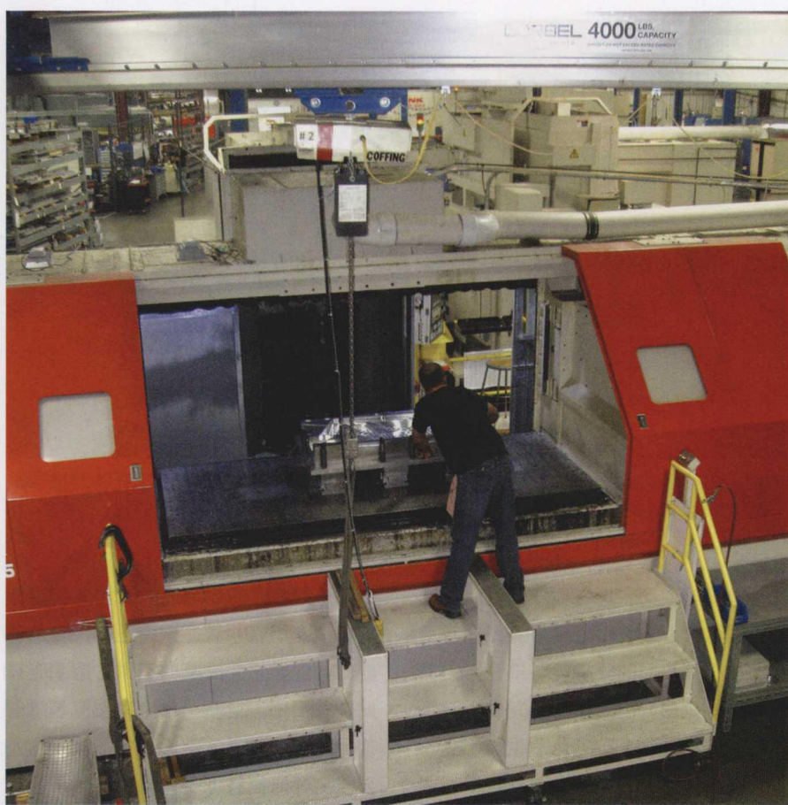
图1 将 Tech Manufacturing 公司的一台五轴加工中心用于铝制零件的加工。监控机床的目的看似是更高效地发挥机床的能力，但实际的益处是更高效地发挥员工的能力。低效的系统要求员工与低效进行对抗，但在具有良好工程设计的系统中，人们知道该做些什么并且能高效地执行每个任务
