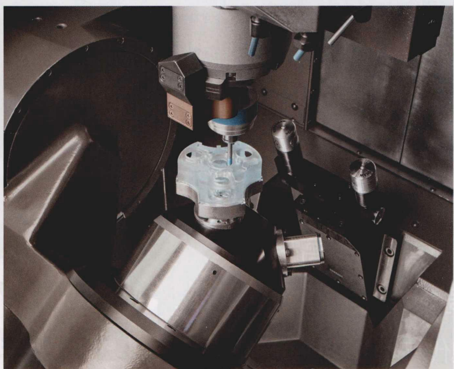
图 1 主轴（蓝）上的固定感应线圈频率激发超声波加工头产生振动。图为使用超声波加工典型磨具进行加工，已有实践结果表明，使用传统工具同样有效
