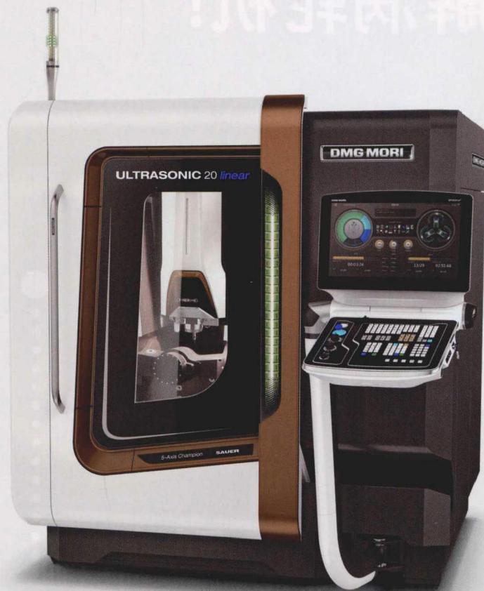
图2 超声波加工中心也是全能型传统加工中心。Wallace 表示，此类设备多将超声波头嵌入零件主轴进行传统的金属切削作业，这项功能在各类作业中应用最为广泛
