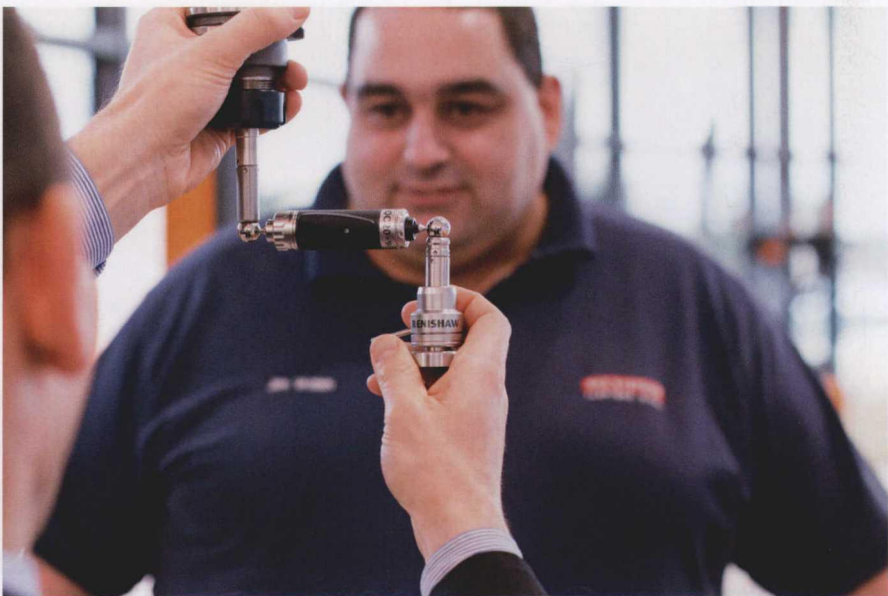
图 5 BAE Systems 员工 Jim Walsh 正在使用雷尼绍 QC20-W 球杆仪
