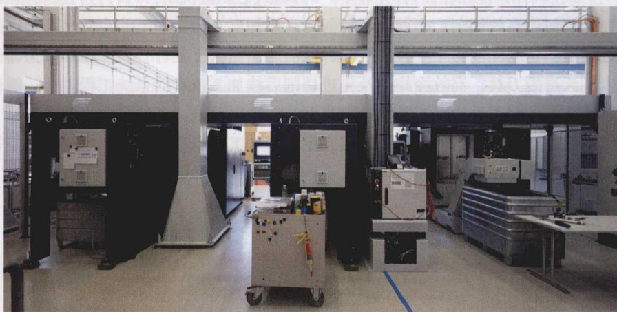
图 5 客户的生产安全可以通过不同叶片类型（80 ~ 200mm）的全自动加工实现
