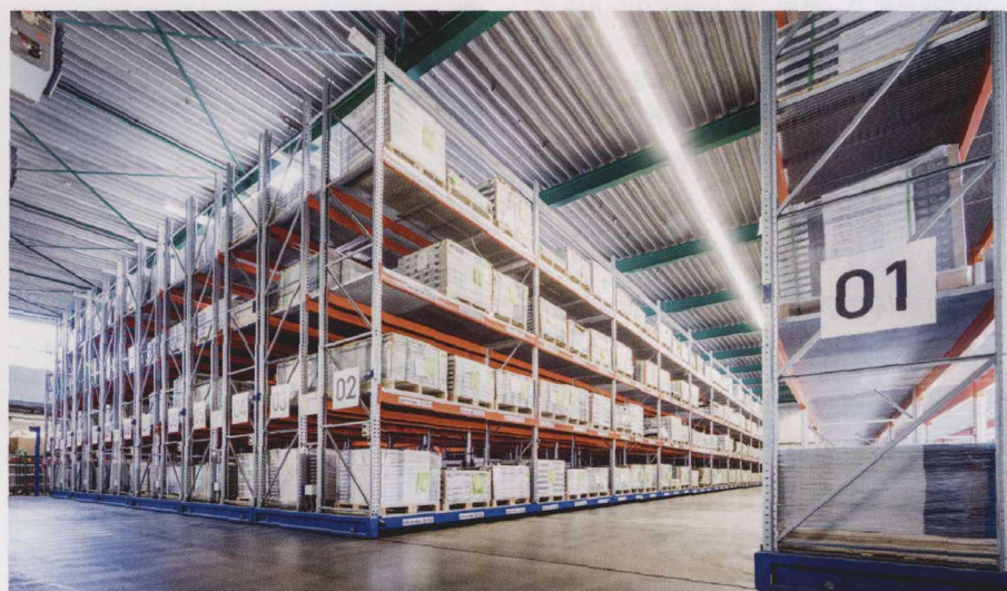
图 3 按一下按钮移动式货架系统就可以打开了 Jan Anstoetz 公司使用的移动式货架系统共计 1400 个架口
