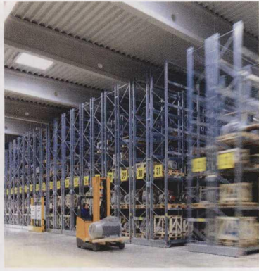
图 6 移动式货架系统大大的节约了厂房占地面积，提供了快捷、方便的物资存取
