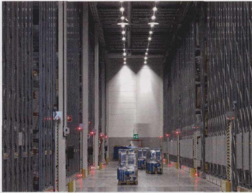
图 5 Movo 重型移动式货架系统的最大高度可达 12 m，长度可达 90 m
