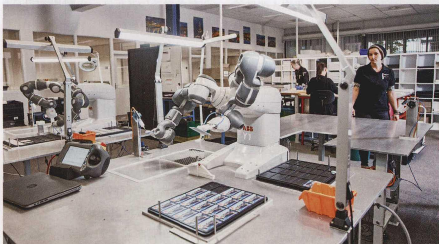
本质安全型设计的双臂机器人能够在不采用特殊防护措施情况下与生产工人携手合作，共同完成生产任务
