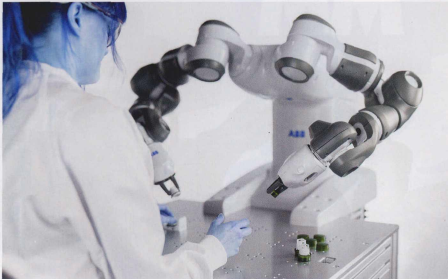
ABB 公司研发生产的 Yumi 机器人被视为第一种协作式机器人。它使得人与机器人之间安全地直接协作成为可能
