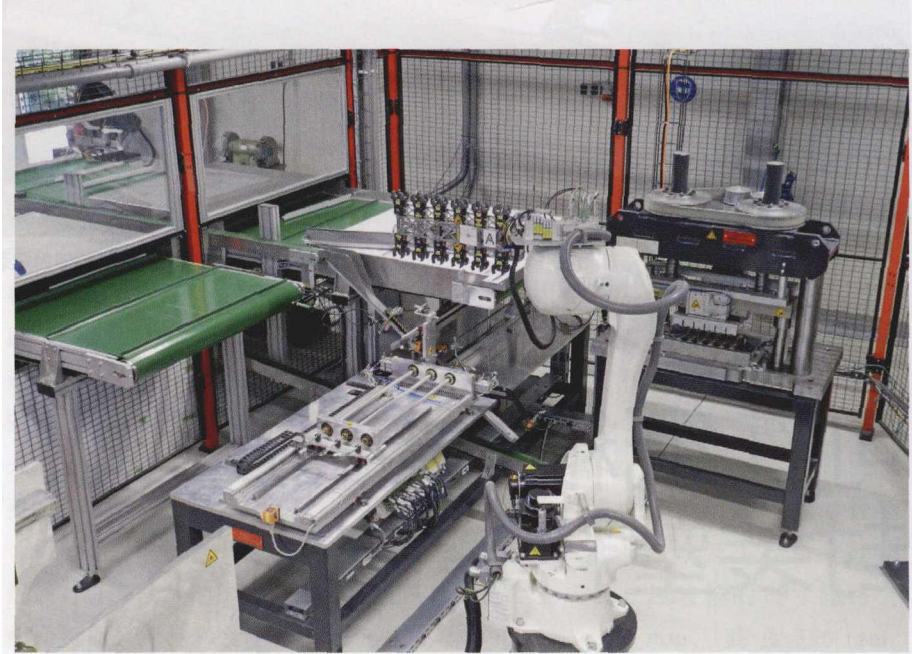
RS020N 型川崎机器人能够在一个工作区中完成全部管材加工任务
