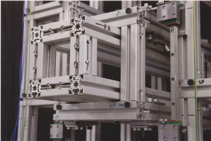
图 1 ISW 所展示的系列化机床轻结构的样机
