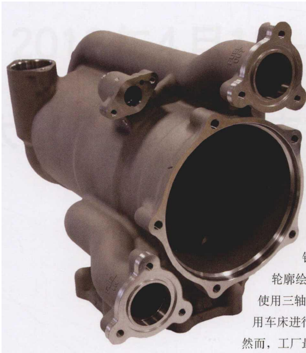
图 1 LeanWerks 开发了一项将刀具、工件夹具和零件探测技术融为一体的工艺，车铣使用这项工艺可以一次加工熔模铸造部件的五个面
