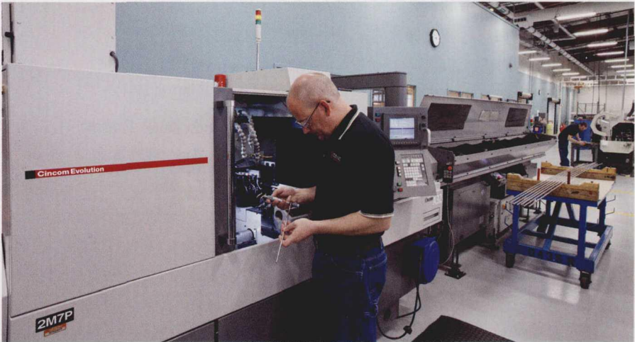
图 5 项目工程师 Kelly Wright 选取了一个在该公司走心式自动车床上生产的零件，对其进行了测量。长久以来，车间测量在此处已成为了一种规范操作，并且在某些情况下还会进行加工过程中的测量。然而，即便对于各类新型的、更为复杂的产品，往往也会在坐标测量机上采用简单的测量方法（借助手持式仪器）来获取更全面、更可靠的形状数据
