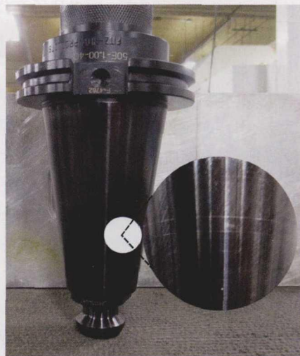
图 1 Hansen 工程有限公司在左侧的刀夹处使用了一个标准固定旋鈕。然而，锥状变形阻碍了刀夹与数控加工机床的主轴正常配合。右侧照片展示了在刀夹内使用 JM 高性能产品公司的高扭矩固定旋鈕的情况，与前者形成了对比。加长设计使得旋鈕到达刀夹螺纹孔更深的位置，提高了锥形接触的质量
