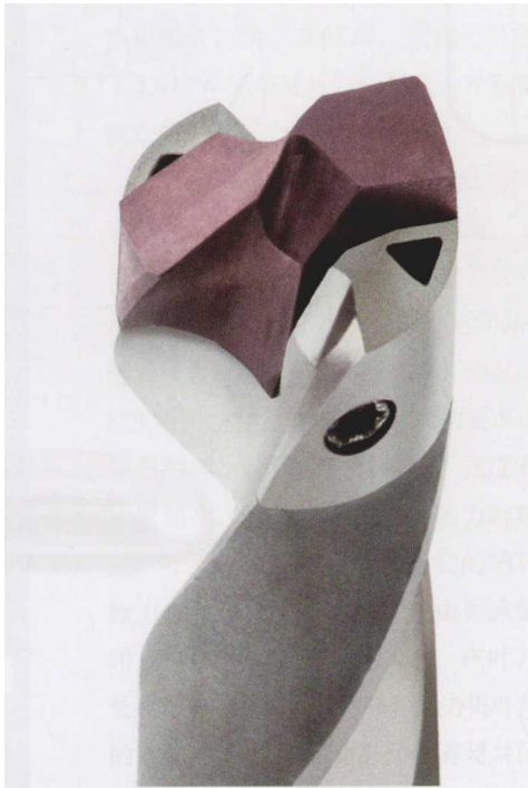
图 1 激光熔融钻头中的冷却液通道配有一个三角形横截面,据 Mapal 刀具公司称,它是一项技术改进,可使冷却液的流量提升多达 30%
