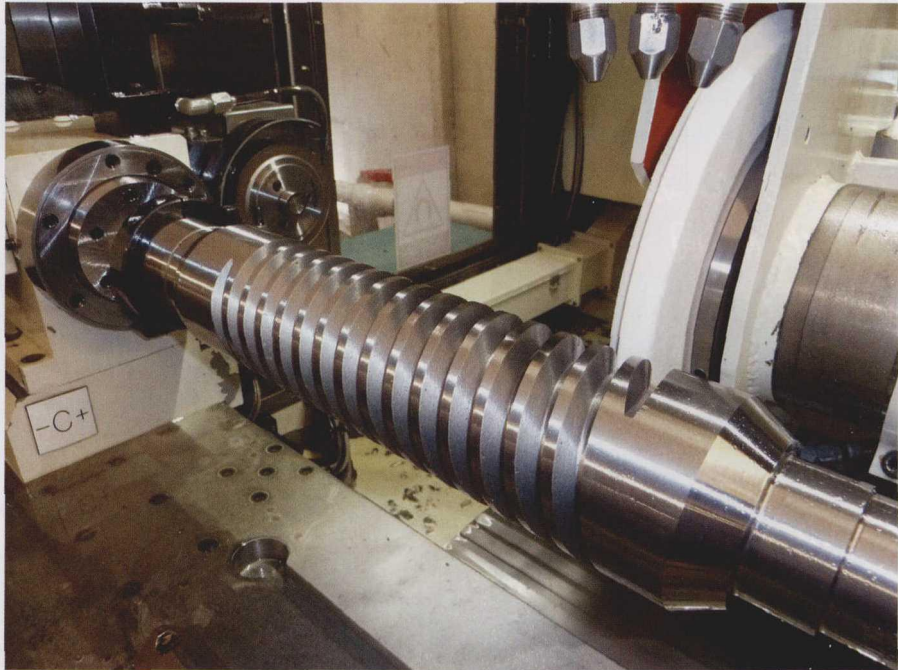
图 1 Tracey Gear & Precision Shaft 公司近期从人工机加工升级至数控机床螺纹磨床，利用此螺纹磨床，可在单个机床上将螺纹形状从坯件切削成完工零件，而不需要提前进行材料器械或最终抛光
