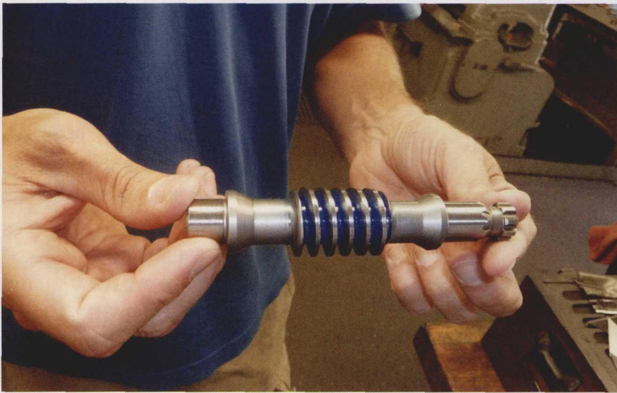
图 3 利用新型数控螺纹磨床，该公司可在大型主轴和更小组件上磨削螺纹，从而在该公司能完成的加工任务上提供灵活性
