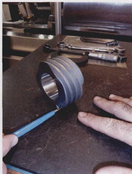
图4 这款四线蜗杆是在 Tracey Gear 公司的 Drake 螺纹磨床上在热处理之前经过粗加工的，现在在该机床上正在等待精磨
