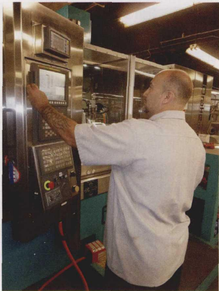
图 2 Drake GS:TE 200 上配备的 FANUC 控制装置，该控制装置具有可访问的人机界面，该公司表示该人机界面能使得加工作业比人工机床快得多，而人工机床只会利用交换齿轮
