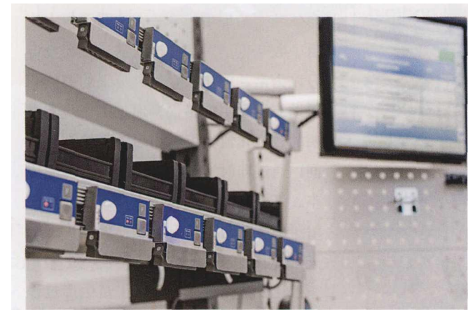
图 3 工位配备了以串联方式连接的 Pick-to-Light 专业显示器以及干预控制器
