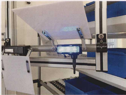
图 7 干预控制由快门控制。图中显示的是一个快门和已被打开的前盖
