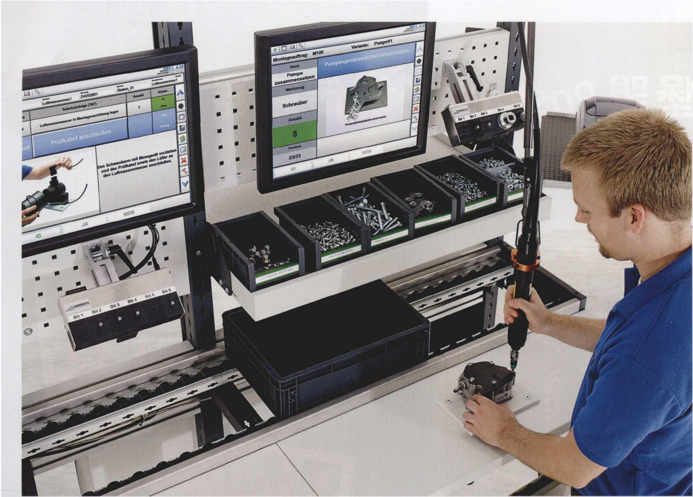
图 1 辅助系统通过显示器帮助工作人员进行手动装配
