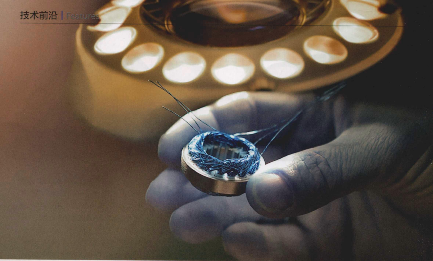
图1 一家驱动器专业生产商根据客户的个性化要求生产无外壳电机
