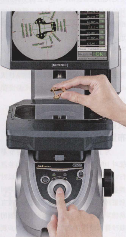
图 3 通过采用 IM 系列数字测量投影仪，最多可以对 99 个特征点作出测量
