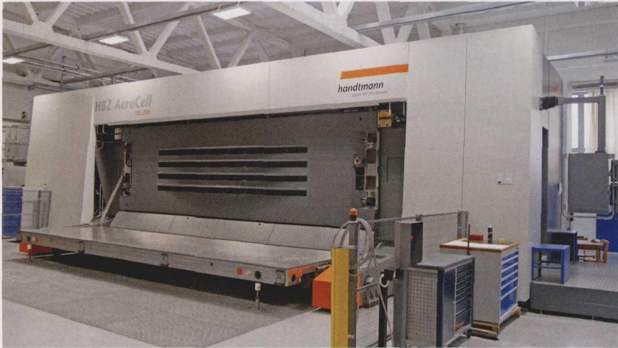
图 3 HBZ AeroCell 700/200 型五轴卧式加工中心配备有大功率主轴，由此可以实现最大切削效率并缩短加工时间
