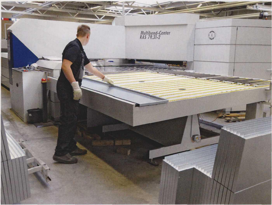
图3 折边之后的成品件到达一个缓冲台上，在这里由一位操作人员取走
