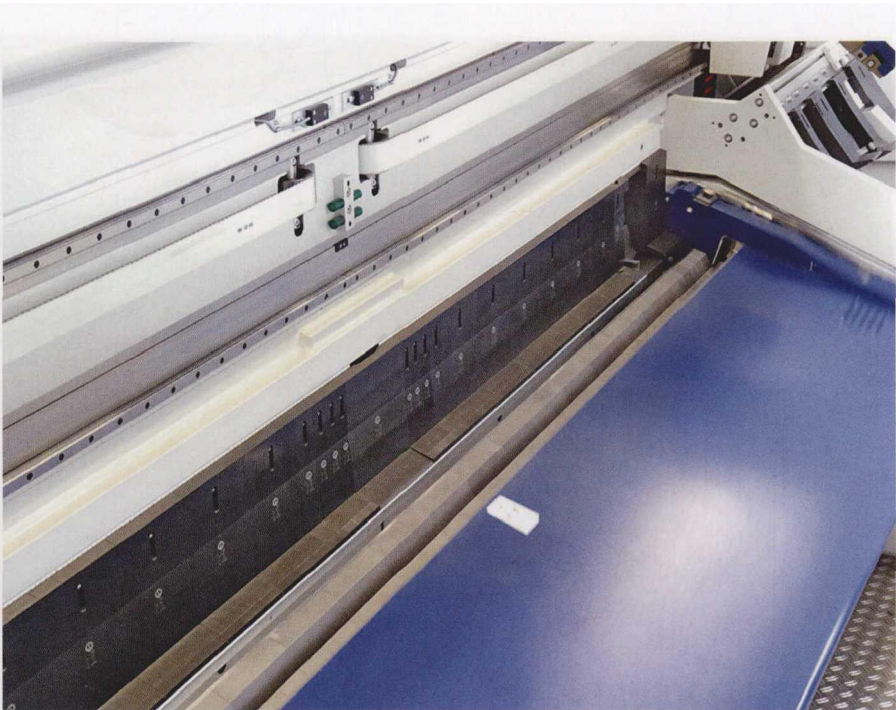
图 5 RAS 折边机在回转折边时可以达到很高的精度和很快的速度
