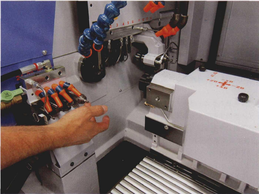
图 1 Bar-fed 瑞士型机床可以实现远距无人照管操作，2017 年，使用该机床的 Top Shops 占比为 32%，相比 2016 年的 19% 有所增长
