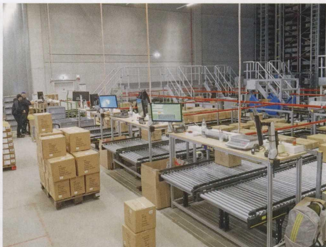
图5 结构紧凑的工作位置以及最短行走距离极大支持了人工配货拣选过程
