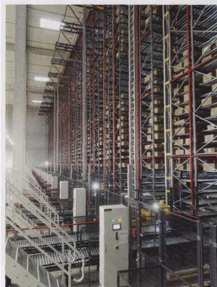
图 3 100 m 长的货架共有 16 条通道；Stöcklin 物流技术公司的 BOXerD1 型高架叉车可以在这 16 条通道中穿行
