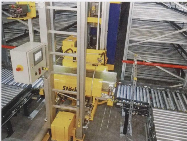
图4 纸箱夹钳能够灵活的抓取各种规格型号的纸箱和周转箱
