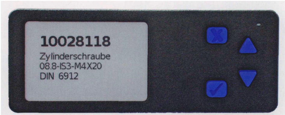
图 1 利用智能手机 App 软件可以将数字式货架标签 I-Display 与 Würth 工业技术服务公司的库存管理系统联系起来，它能够直接识别与其相耦合周转箱的内容和位置
