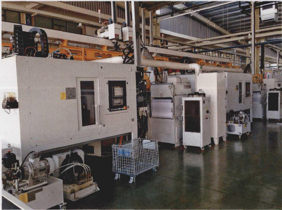
图 2 STAMA 公司提供的全自动化中间轴承壳体生产线，整合了两台 STAMA 车铣复合加工中心 MT831 TWIN，实现了中间轴承壳体的两次装卡完成全部加工，一举取代传统工艺中的四次装卡加工，极大地提高了加工精度和生产率
