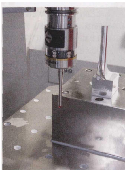
图4 使用触发式探测技术加快安装速度并进行自动校准。对于后者，测头找到磨制耳轴臂铸件和 C 轴电机的外壳铸件的棱柱位置并进行调整，补偿工厂内环境温度波动导致的任何轻微移动
