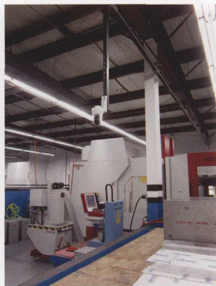
图 6 Phoenix Proto 已经安装了一个摄像头，通过摄像头可以查看三轴和五轴 Roeders 机床。这样工厂人员就能使用智能手机远程查看机床工作区域或数控加工屏幕，确保机床在无人值守运行时不出问题
