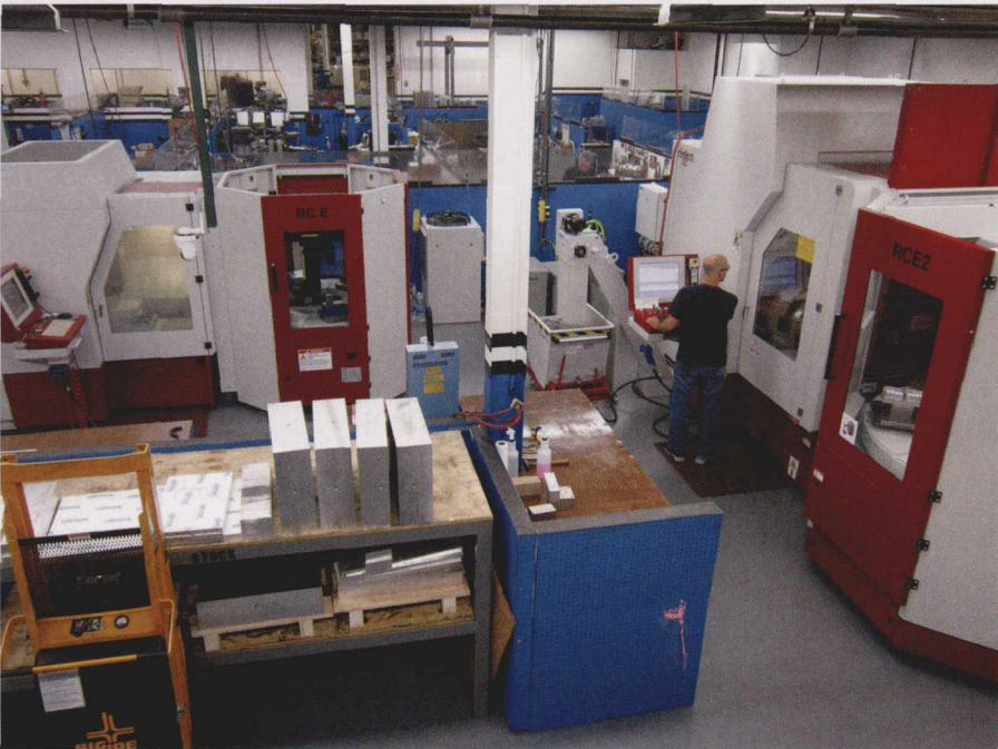
图 1 工厂的两台 Roeders 机床（左边的为三轴，右边的为五轴）包括一个共用托盘和装载系统，可以进行长时间的无人值守加工
