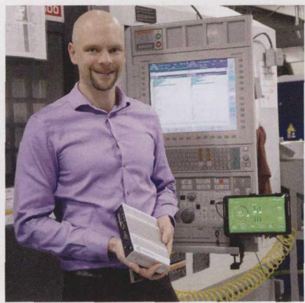
图2 Eric Fogg 建议安装图示类型网关设备，将机床网络与公共互联网隔离开来。这种硬件设备价格低廉，安装后即可使用，通过两张网卡管理网络数据的输出输入
