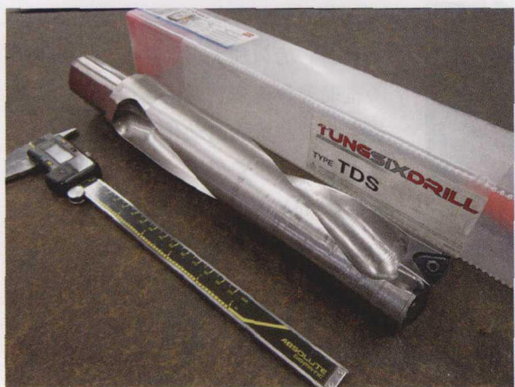
图2 该机床主轴扭矩大，Z轴进给力大，能够适配大型刀具，如Tungaloy生产的直径为2 in的刀片式钻头。此前，工厂需要1~12 in，锥度为0.003 in/ft。操
