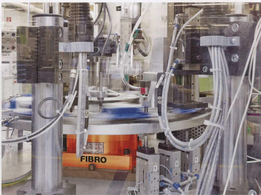
Fibrodyn DM 紧凑型高速圆形工作台为装配设备设计工作打开新的自由和灵活的空间
