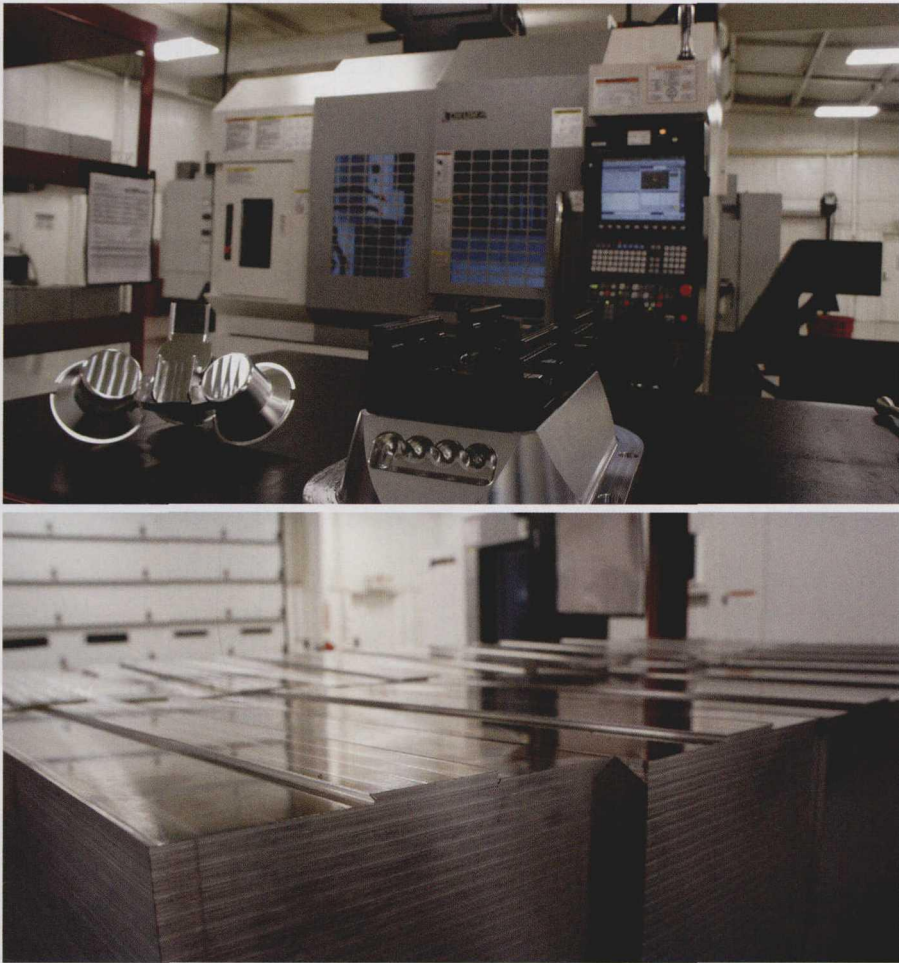
图 4 五轴操作使用第五根轴工件夹紧装置，通过三轴 VMC 上加工的 0.08 in 榫头夹紧零件，与背景中所示的 Okuma Genos M560V 相似
