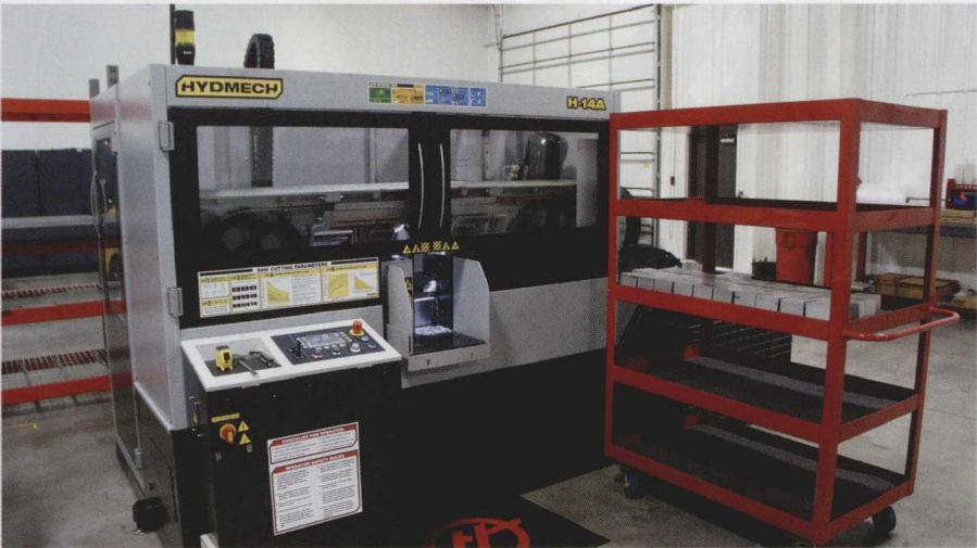
图 5 切割工件的数控加工带锯（Hydmech H-14A）最初看似很有“杀伤力”
