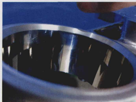
图2 山高 BF41860 导条式铰刀,加工参数为 V_c=400 m/min, f_z=0.3 mm/z,加工效率保持非常好的状态,表面粗糙度和圆度都满足了需求,可同时用于自动线的生产环节
