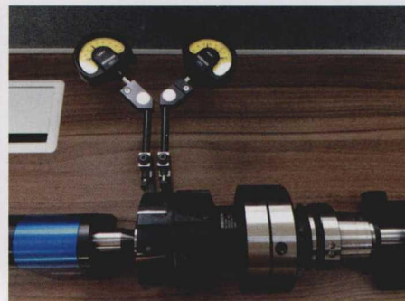
图2 山高 BF41860 导条式铰刀,加工参数为 V_c=400 m/min, f_z=0.3 mm/z,加工效率保持非常好的状态,表面粗糙度和圆度都满足了需求,可同时用于自动线的生产环节
