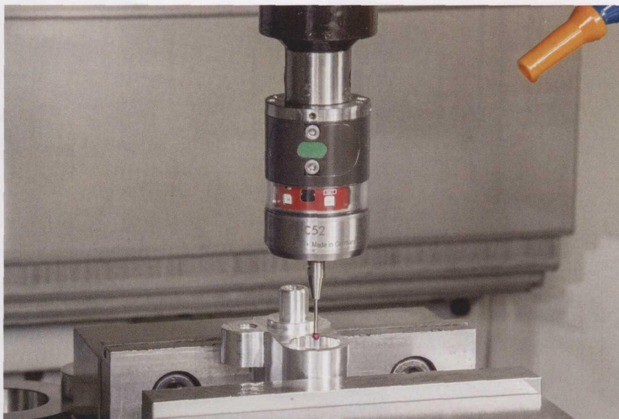
图 2 Blum 探测器的触觉优化新的 VMC，如果 Blum TC50 接触式探头探测到问题，将停止机床或解决问题
