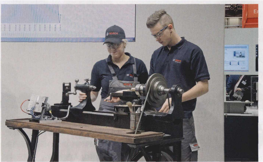
Bosch Rexroth 通过对旧车床进行改造证明即使是老旧设备也可以通过网络相互连接起来
