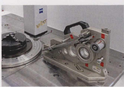
使用测试样密切检测测量仪器的准确度，提高了测量过程的安全性
