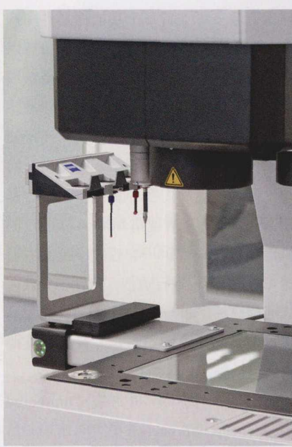
变焦镜头，自动移出坐标测量仪的检测区域，充分利用了现有的检测区域”
