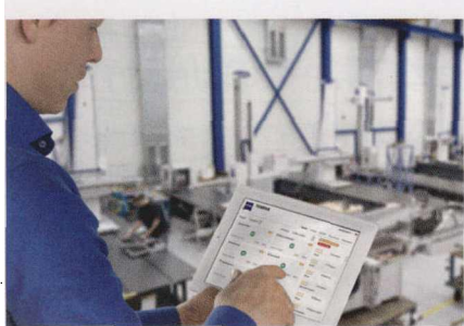
Zeiss Tempar 通过不同探头获取实时温度。如果有不可信的变化出现，系统会提示使用者
