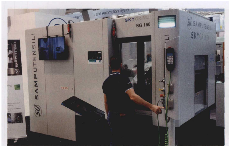
图2 该机床的轴体设计使其更为紧凑，且由于不再需要冷却液，得以进一步节约空间。通常，在制造企业中，冷却液系统至少和一台机床占地面积等同
