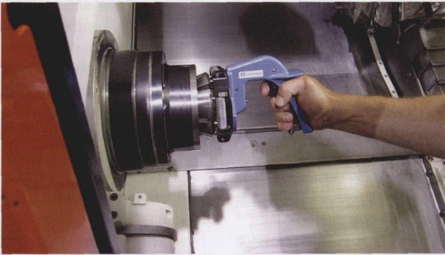
图 3 FlexC 系统加速了向加工新尺寸棒料的转变，并在筒夹和棒料之间提供了足够大的表面接触面积，确保了刚度
