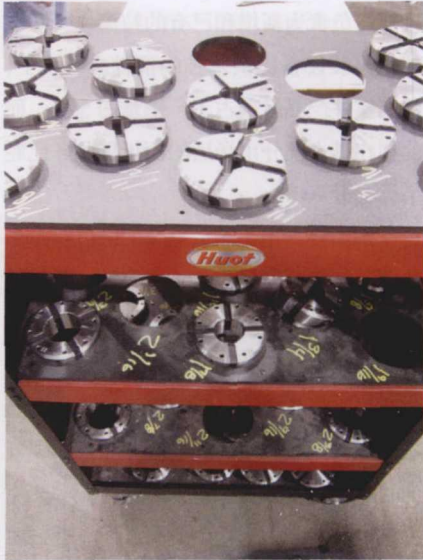
图 4 True Die 公司使用 Hardinge FlexC 快速更换筒夹系统对直径达 3.25 inch 的工件进行硬车削
