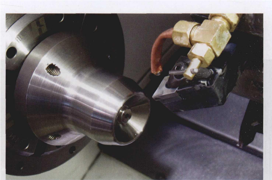
图 1 True Die 公司使用硬车削技术生产圆形模具，如图中所示
