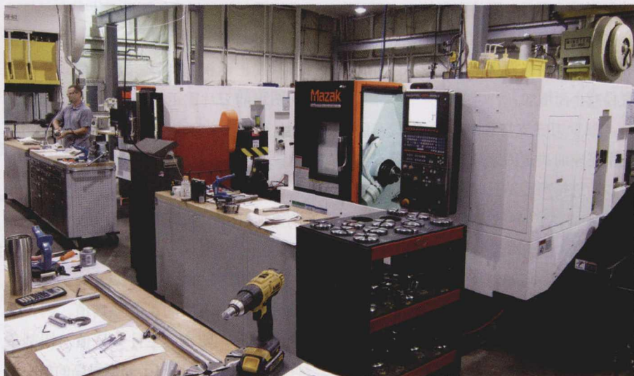
图 2 这两个 Mazak Quickturn Nexus 型设备主要用于硬车削。它们的混合滚子导轨系统提供了硬车削加工所需的刚度
