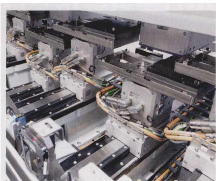
将工序分成八个同步的进程加快了装配频率，使故障排除更简单，由此达到了每分钟600个弹簧的安装速度
