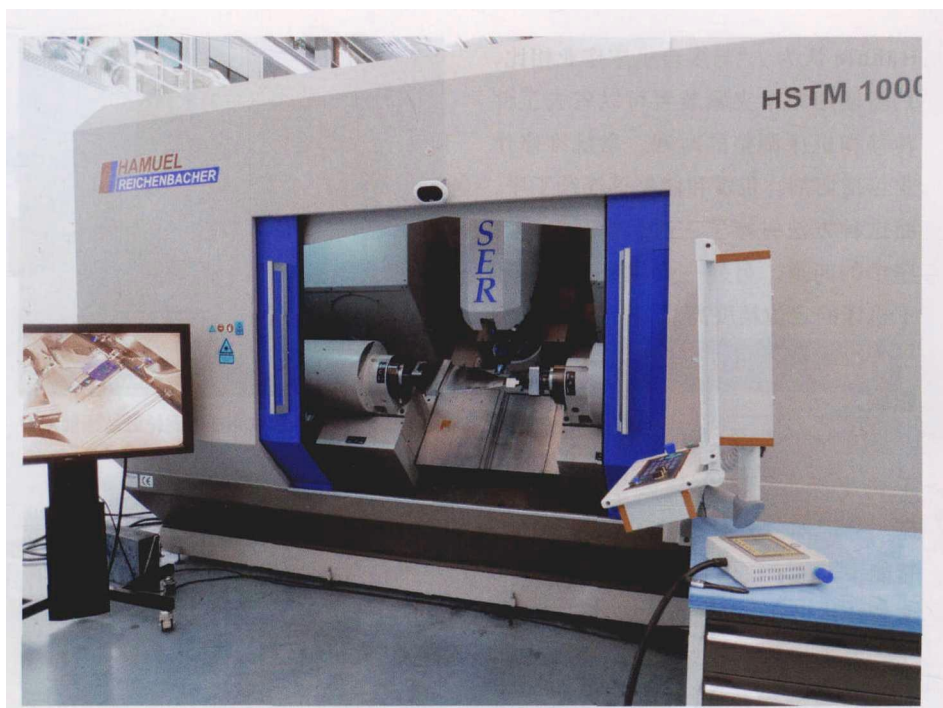
图 2 图中的 Hamuel 车铣复合机床是一台“组合式”机床，能够在同一循环内完成金属增材和精密制造。该机床的增材制造能力得益于其安装的“Ambit”加工头。这一金属沉积头和机床刀柄共用一个主轴连接接口
