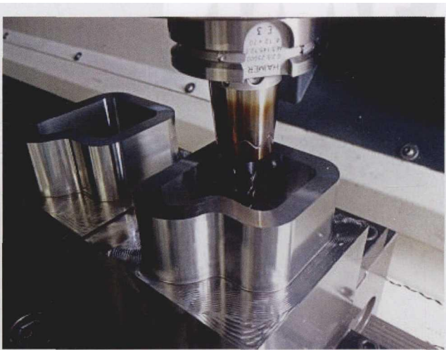
图 3 即使在加工难加工材料时，例如不锈钢或者钛合金，通过提升切削深度，铣削加工的效率可以提升三倍。理想的立铣刀是带 Safe-Lock™ 安全锁系统的 HAIMER Power Mill 翰默强力型立铣刀
