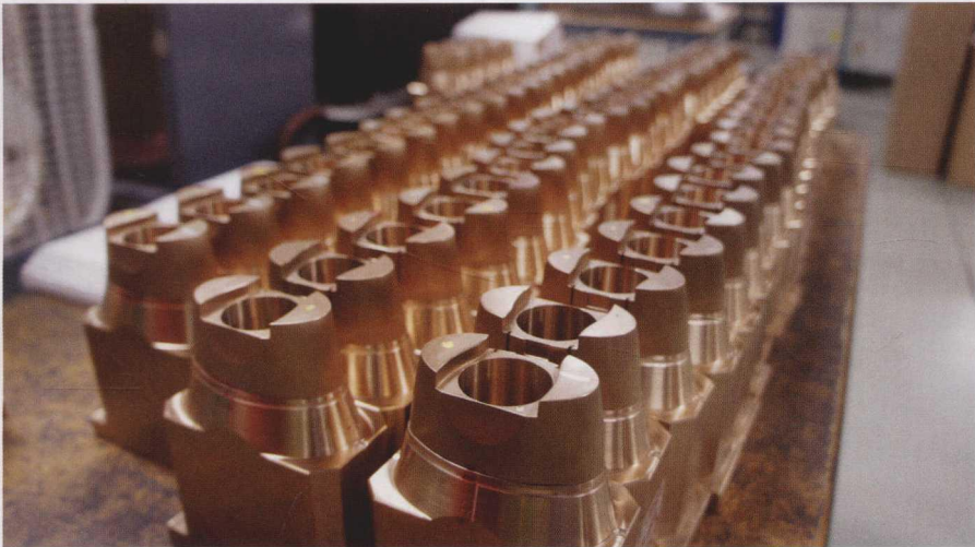
图 4 包含在每个洗发香波瓶刀具叠层中的另一个部件，这些具有高导电性的铂铜芯体与交叉水线层叠，以便在注射循环之间更快地散热。虽然每个模具各不相同，高气蚀工装需要这些体积的零件和电极，即自动化不仅仅是诸如 DynamicTool 这样的机床厂所需要的，而且是必不可少的
