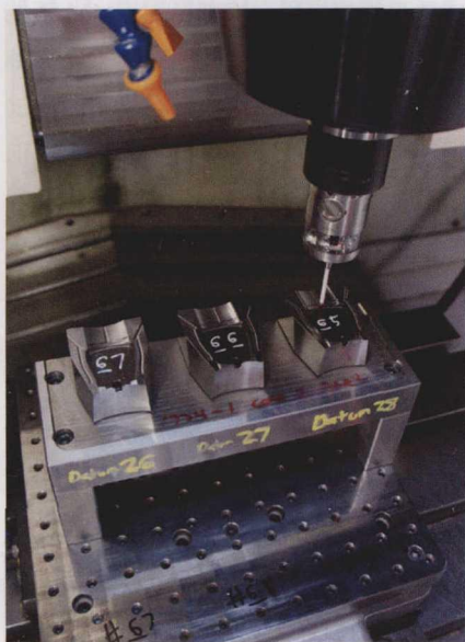
图2 每一个这些“盖子插件”都是构成用于铰接洗发水瓶盖 2 \times 24 堆叠注射模具单独堆叠的 20 个部件之一
