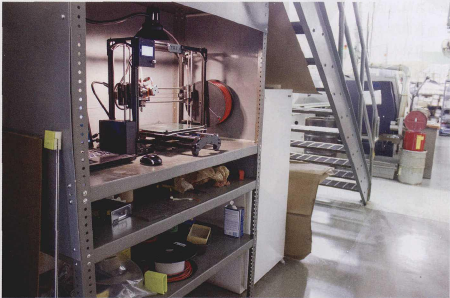
图 1 Swiss Automation 公司生产的 LulzBot Taz 5 放置在连接 Barrington 机加工车间两侧的走廊楼梯下面，往左可以看到一台 3D 打印设备，其有机玻璃护罩横跨机柜的前部，以防止 3D 打印机在运转过程中碰触到车间内的油和其他碎片
