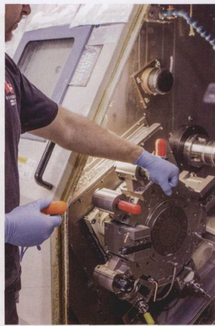
图 2 机械工程师 Daren Johnson 在 Swiss Automation 公司生产的 Eurotech 车削加工中心内安装刀具护罩。在某些情况下，员工仅在距离车床转塔刀架数英寸远的地方操作，这些安装护罩可提供必要的防护，以防止碰撞、割伤和擦伤
