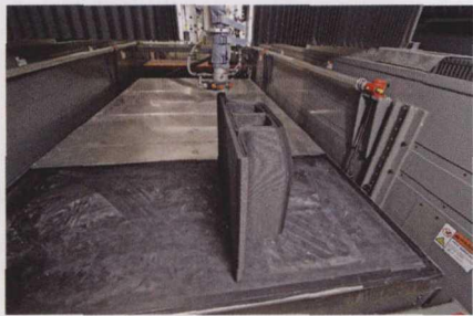
图3 已经证明该设备升降行程具有一定价值。由于3D打印工装形状与X-Y工作台通常意味着添加支撑结构，因此经常以其Z向长度打印工具
