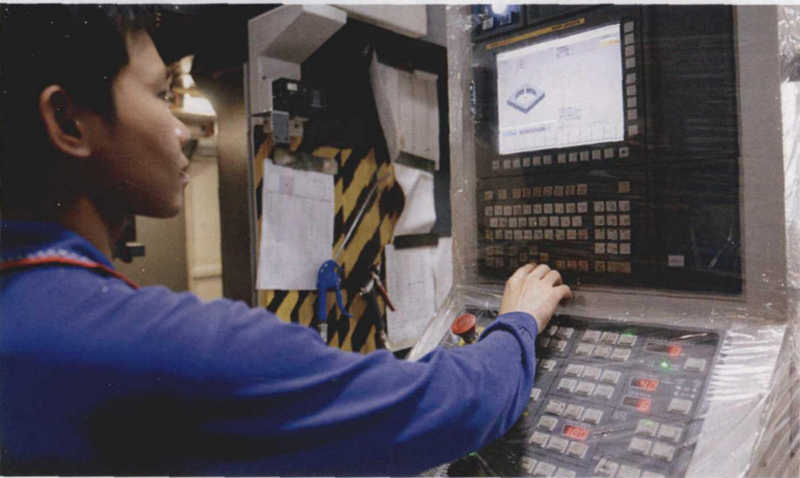
图 2 操作人员正在使用雷尼绍 GUI 和 RMP60 测头测量模座孔位尺寸
