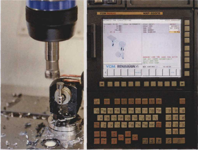
图 3 RTS 配合雷尼绍 GUI 测量刀具
