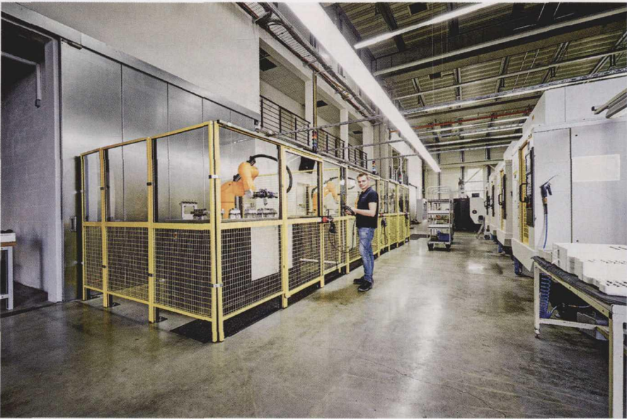
图 4 针对汽车工业的机器人领域，对陶瓷部件进行打磨和抛光。该部门已经成立一年时间，每天 24 h、每周 7 天作业
