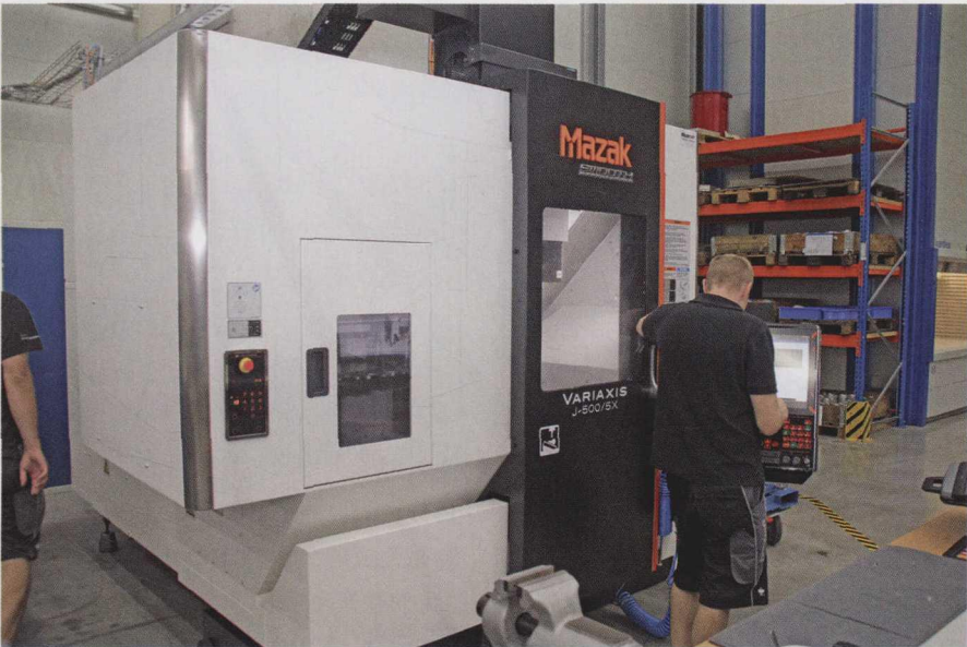
图 3 已经共有四台 Mazak Variaxis j-500 5X 型五轴模拟加工设备被应用在 toolcraft 公司车间里
