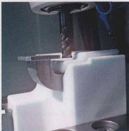
图2 用于加工零件形状的3D打印夹钳可以将零件密封在工件夹紧装置内
