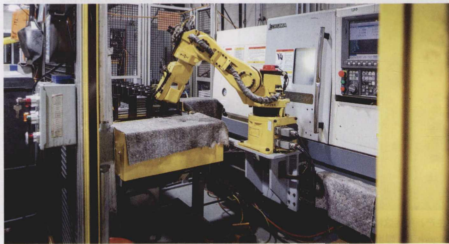
图 2 Kilgore 加工工厂的专用自动化单元一周可生产 3500 个法兰配件
