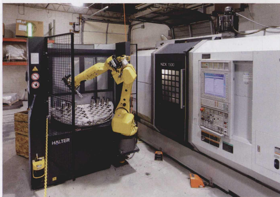
图 1 Halter 提供的 LoadAssistant 是一套灵活的自动化系统，能够从任何数控机床装卸零件。该系统可轻松转换，帮助用户实现各类小作业量工种的自动化生产
