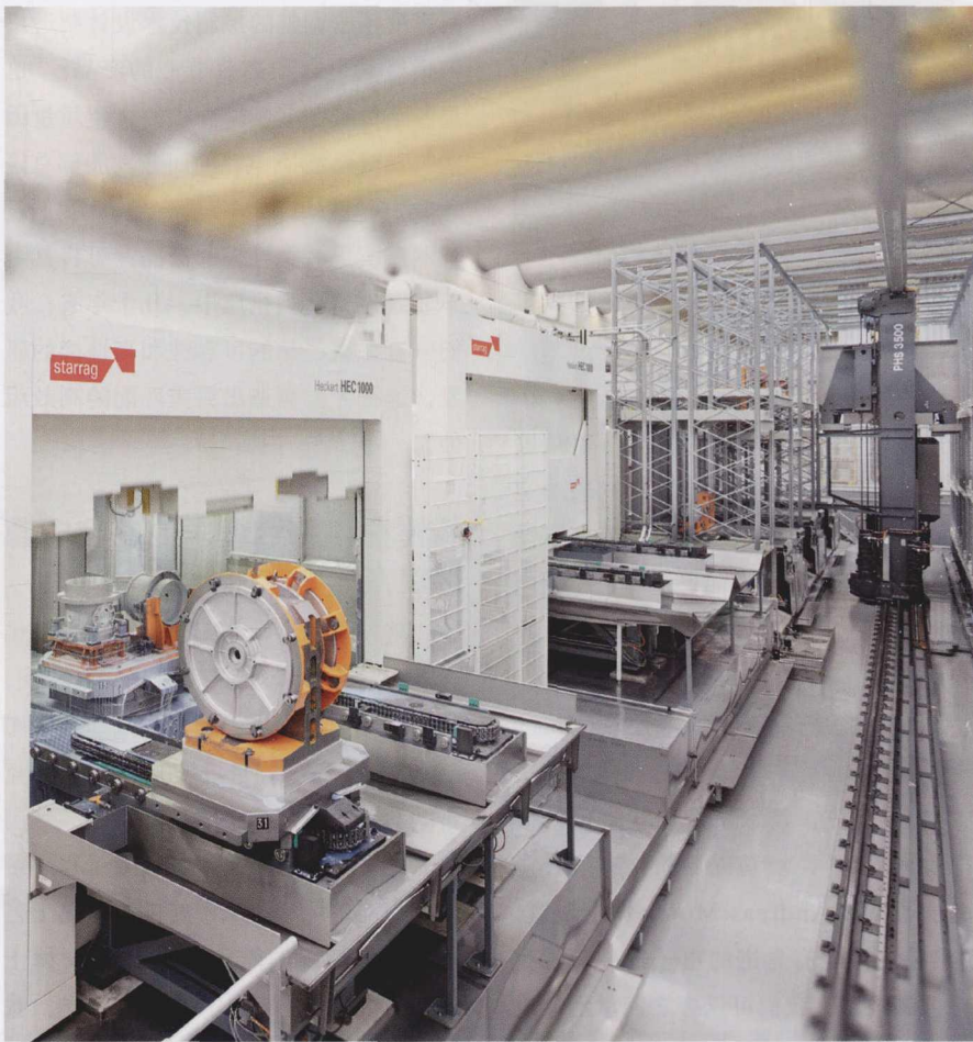
图 1 符合人体工程学的设计：应客户要求，斯达拉格把海科特加工中心沉入地面 750 mm，目的是通过地面可及性简化搬运，由此提高生产率
