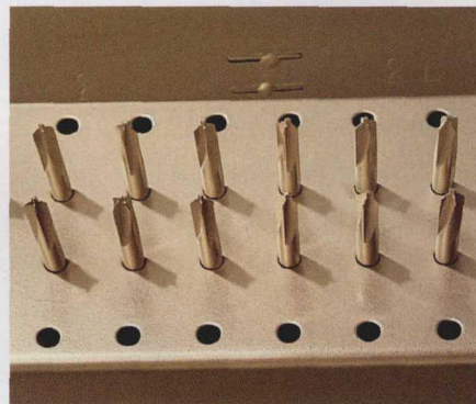
图 2 采用了 PVD 镀层的刀具的寿命是未进行涂覆的刀具的十倍
