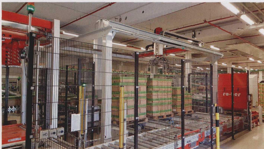
图 2 Reca Norm 公司是工具和夹紧技术方面的专家，该公司采用龙门式机器人实现托盘码垛
