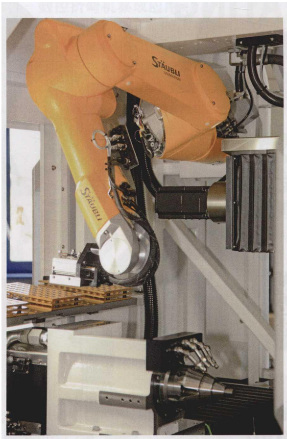
图 1 Stäubli 机械手在 Strausak 磨床上自动装入刀座
