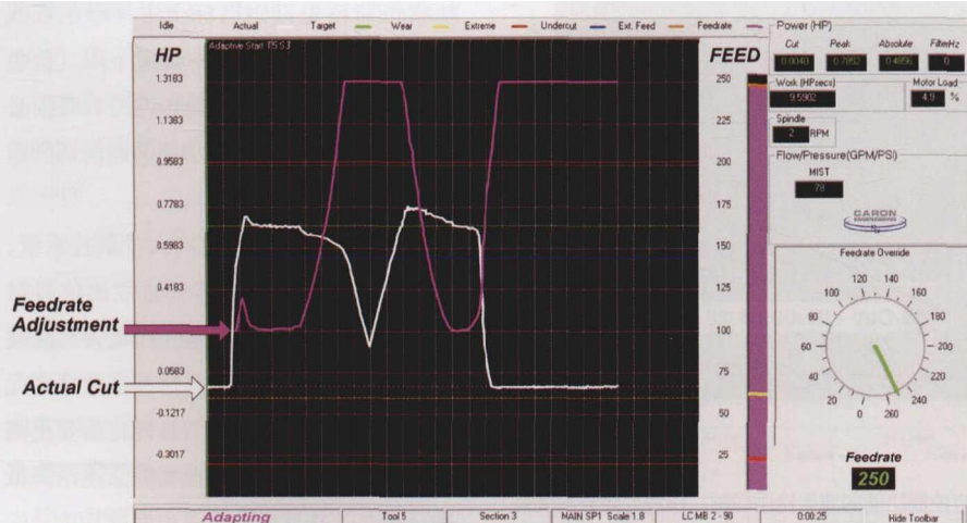
图 4 这是同一种切削，但采用了先进的自适应控制技术。在这种模式下，TMAC 可以完全控制进给速率（由紫线表示）。随着切削条件变得困难，进给速率会下降，反之亦然。传统的自适应控制可以针对各刀齿的每次上升和下降调整进给速率，Caron Engineering 公司的“锯齿算法”知道每次旋转将穿过材料的齿数或槽数量，因此为整个刀具旋转平均化了这种调整。时间节约效果非常显著，在上述切削中可以节约 20 s
